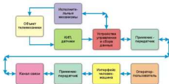
Функциональная схема системы телемеханики
