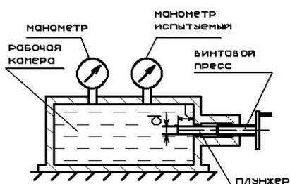
Для тарировки манометров по эталонному манометру применяется винтовой пресс. На какую длину необходимо переместить в рабочую камеру плунжер для создания давления в масле  $p = \underline{\hspace{2cm}}$  кПа, если диаметр плунжера  $d = \underline{\hspace{2cm}}$  мм, а начальный объем масла в камере (при атмосферном давлении)  $W = \underline{\hspace{2cm}}$  см<sup>3</sup>. Коэффициент объемного сжатия масла  $\beta_p = 6,5 \times 10^{-4}$  1/МПа.
