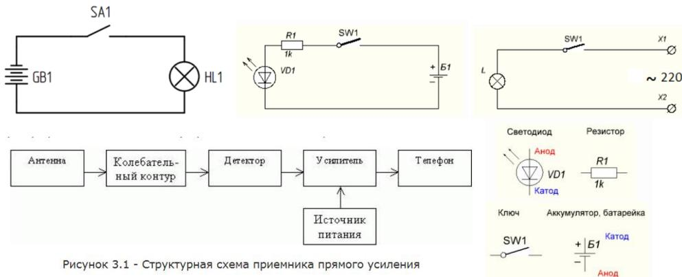
Рисунок 3.1 - Структурная схема приемника прямого усиления
