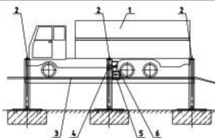
Рис. 4 Подъемник электромеханический грузоподъемностью 8 т
