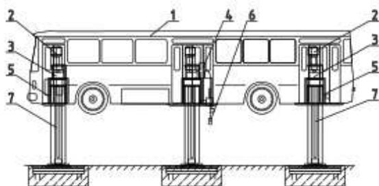
Рис. 3 Подъемник электромеханический грузоподъемностью 14 т (АС №156894)
