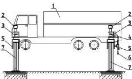
Рис. 2 Подъемник электромеханический грузоподъемностью 5 т (АС №128945)
