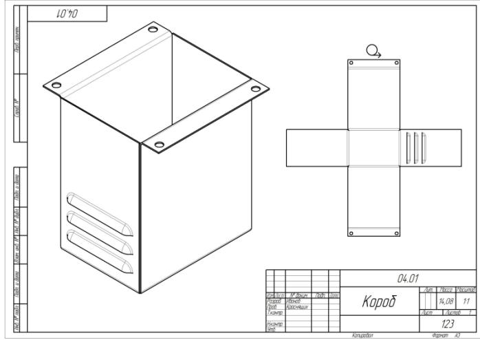
**Задание №5.** Создать чертеж детали по геометрической модели детали, выполненной в задании 3 (чертеж формата А4-А2).
