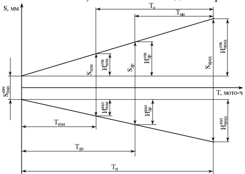
«поршневой палец – втулка верхней головки шатуна» при известных износах этих деталей.
