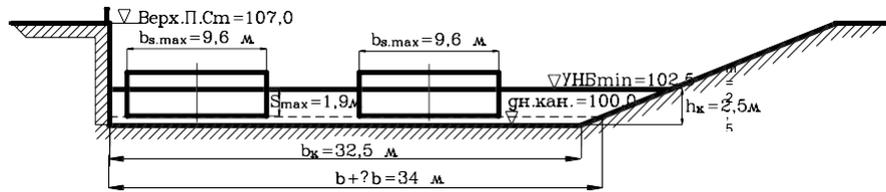
Рисунок \_\_ Поперечное сечение подходного канала судоходного шлюза
