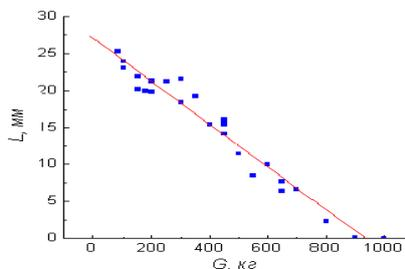
Рис. 3.1 Зависимость веса груза от линейных размеров
