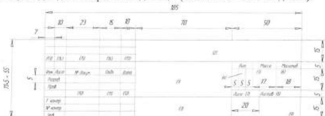
Рисунок. 4 – Форма 1 основной надписи для чертежей и схем по ГОСТ 2.104-2006
