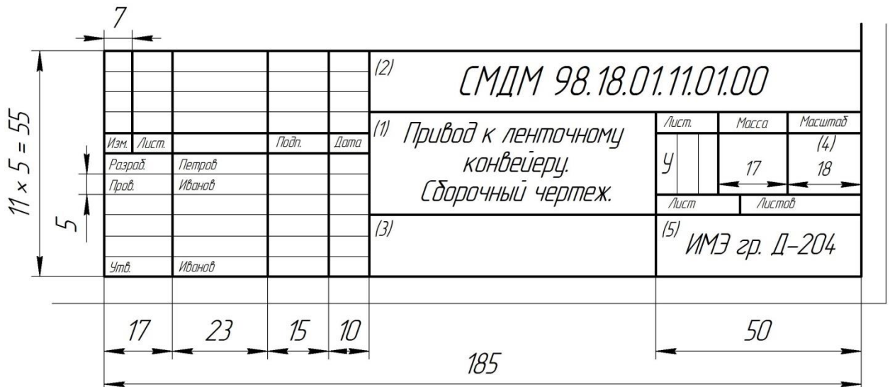
Рис. 4. Основная надпись по ГОСТ 2.10468 для первых листов чертежей и схем
