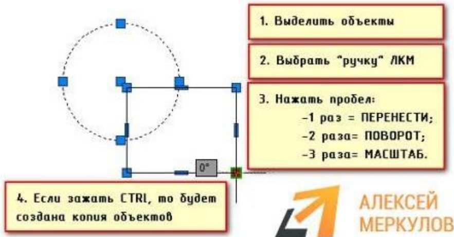
Рис.2 – Быстрый способ переноса объектов в AutoCAD.
