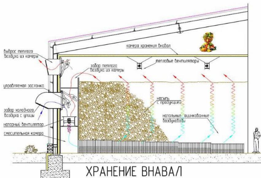
Рис. 3.1 Активное вентилирование картофеля при его навалном
