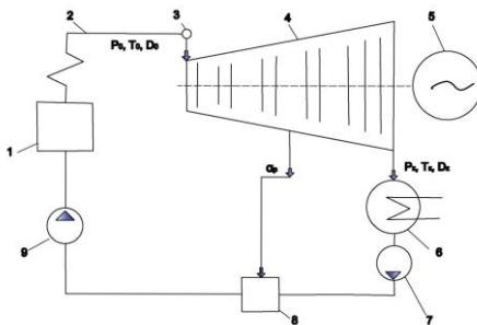
Тепловая схема ПТУ с одним подогревателем питательной воды смещающего типа
