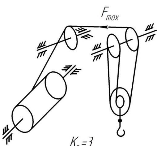
Определить усилие  $F_{\max}$  в тяговой ветви каната полиспаста, выполненного по приведенной схеме, при подъеме груза массой  $G = 20$  т. Полиспастные блоки установлены на подшипниках качения, отводные блоки на подшипниках скольжения. Изгибной жесткостью каната пренебречь.
