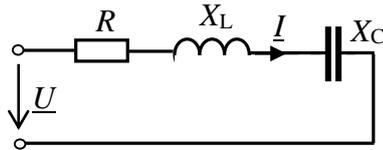
5. В схеме последовательного колебательного контура  $u = 100 \sin 314t$ ,  $I = 2 \sin 314t$ ,  $R = X_L = 100$  Ом. Определить емкость конденсатора.
