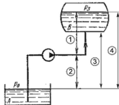
8. Укажите на рисунке геометрическую высоту нагнетания
