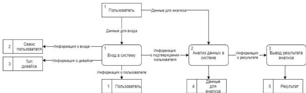
Рисунок 3 – Диаграмма потоков данных системы в нотации Гейна-Сарсона
