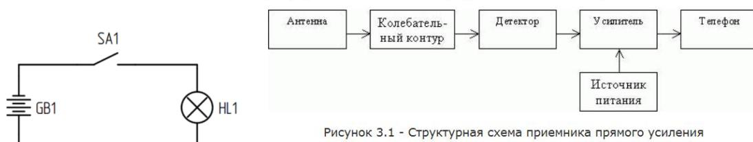
Рисунок 3.1 - Структурная схема приемника прямого усиления
