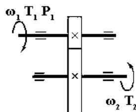
3. Прочитать кинематическую схему, определить ее элементы. Мощность на ведущем валу  $P_1 = 13 \text{ кВт}$ ; Угловая скорость ведущего вала  $\omega_1 = 57 \text{ рад/сек}$ ; Коэффициент полезного действия передачи  $\eta = 0,97$ ; Передаточное число передачи  $i = 8$ .
