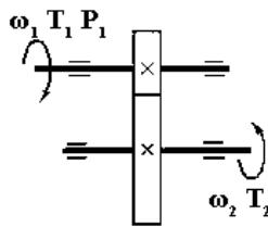
4. Прочитать кинематическую схему, определить ее элементы. Вес груза  $G = 1200$  Н; Скорость подъема груза  $v = 10$  м/сек; КПД барабана лебедки  $\eta_b = 0,9$ ; КПД цилиндрической передачи  $\eta_c = 0,98$ ; Элементы конструкции приведены на схеме.
