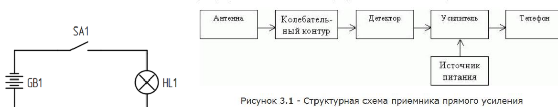
Рисунок 3.1 - Структурная схема приемника прямого усиления
