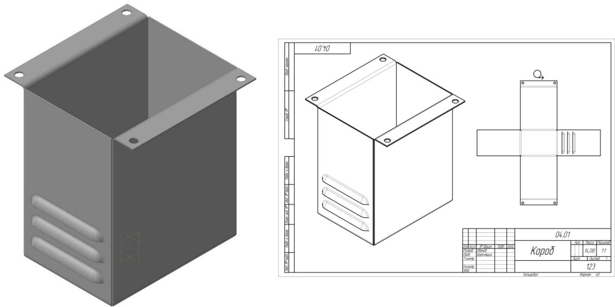
**Задание №6.** Создать чертеж детали по геометрической модели детали, выполненной в задании 3 (чертеж формата А4-А2).
