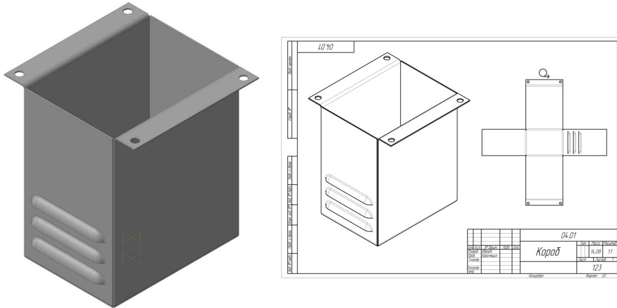
**Задание №5.** Создать чертеж детали по геометрической модели детали, выполненной в задании 3 (чертеж формата А4-А2).
