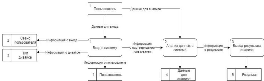
Рисунок 3 – Диаграмма потоков данных системы в нотации Гейна-Сарсона
