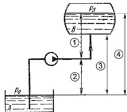
8. Укажите на рисунке геометрическую высоту нагнетания
