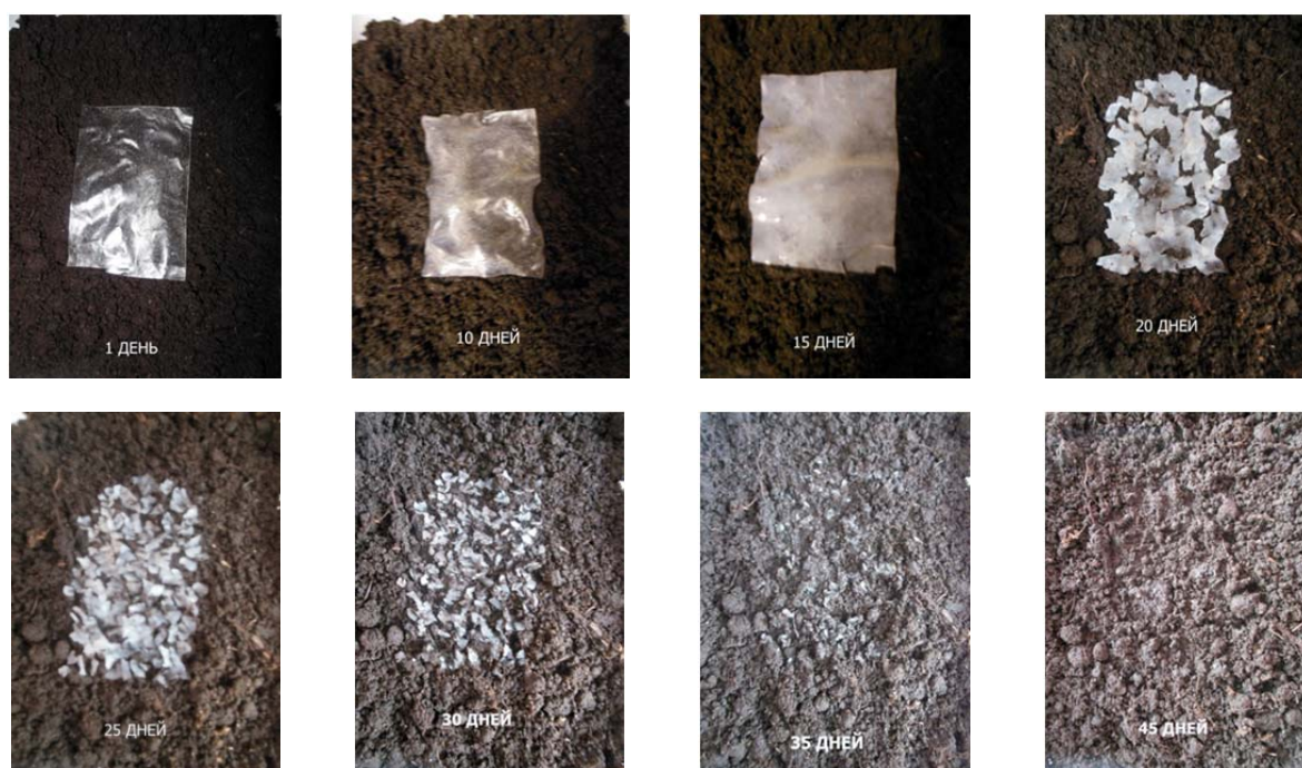
Рисунок 1 – Стадии биодegradации в присутствии влаги под воздействием стандартизованной субстанции с заданным содержанием микроорганизмов Bacillus Subtilis
