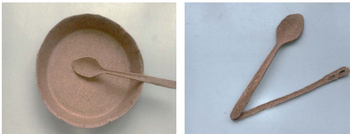
Рисунок 2 – Опытные образцы одноразовой посуды из биоразлагаемого полимера на основе соломы злаковых культур
