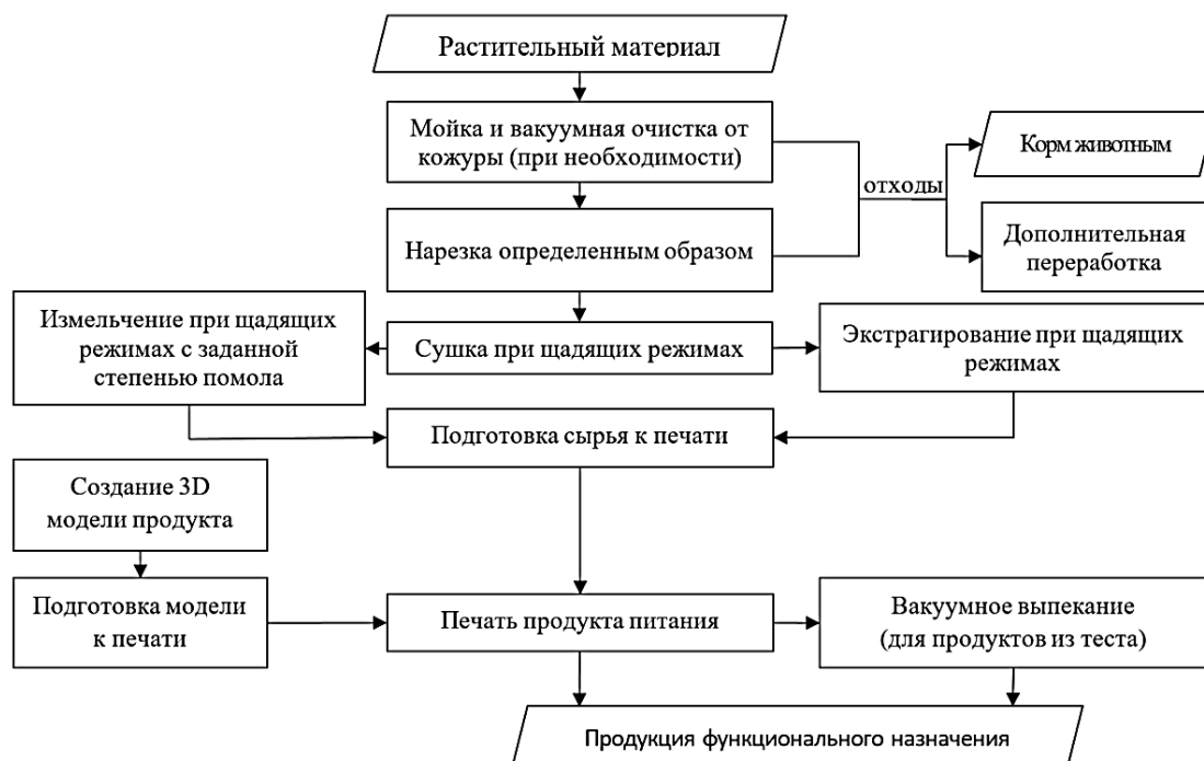
Рис. 1. Блок-схема линии комплексной переработки растительного материала с применением аддитивных технологий
