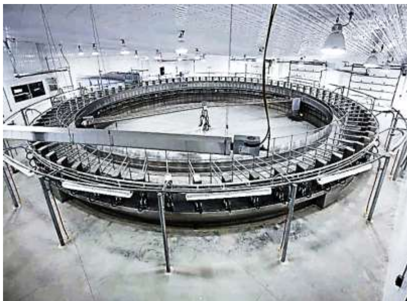
Рисунок 2 – Роторная доильная система DeLaval PR 3100 HD типа «Карусель»
