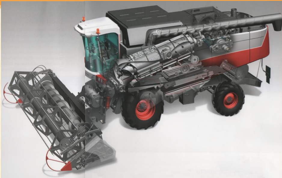
Роторный зерноуборочный комбайн TORUM с вращающейся декой
